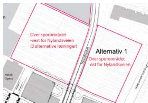
Figur 12 Mulig lokalisering av bussterminal på lokk over sporene med innkjøring fra Nylandsveien.
