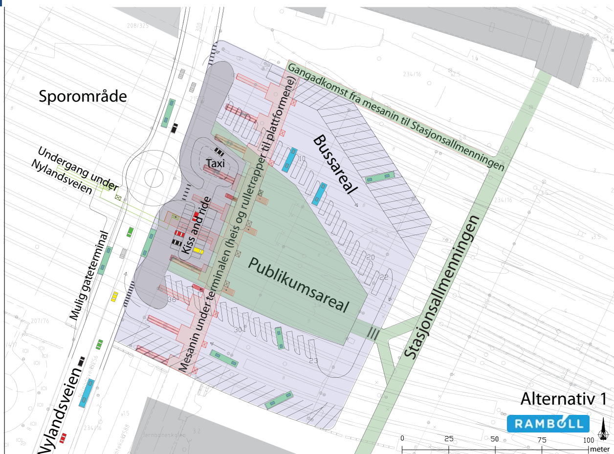
Figur 27 Terminal på toppdekke over sporene med atkomst fra Nylandsveien. Det rosa viser mesalin under lokket som kan nås fra lokket med heis og noen trapper.
